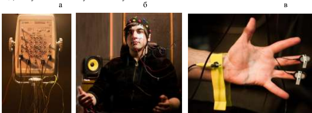
Рис. 1. Общий вид установки (а), методика наложения электродов для ЭЭГ, ЭОГ (б), ЭКГ и КГР (в).
