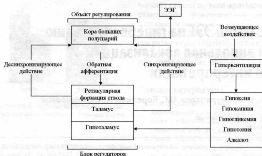
Рис. 1. Блок-схема структур мозга, участвующих в изменении ЭЭГ (состояние корковой активности и регулирующих структур мозга) при пробе с ГВ. Показано регулирующее влияние таламуса, гипоталамуса на кору при возмущающем воздействии ГВ
