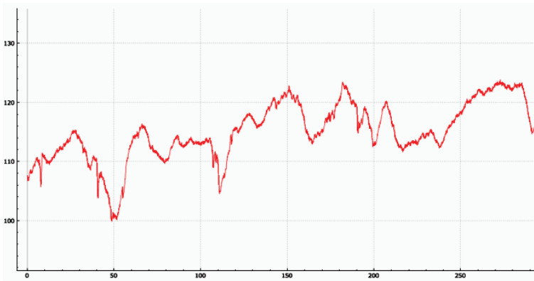
Рис. 6.21. Исходный сигнал в зоне интереса, сформированный из усреднения яркости пикселей в зеленом канале
