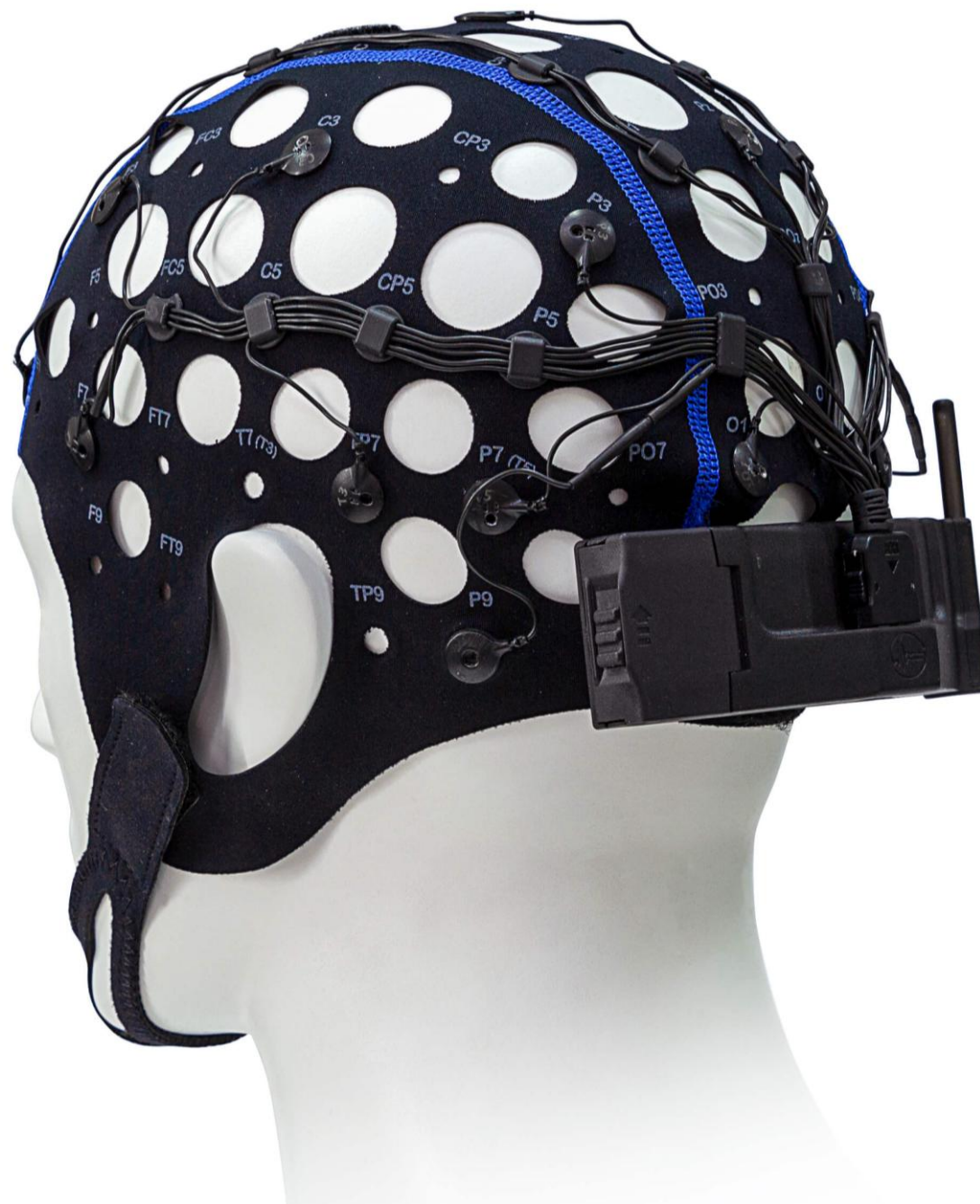
Рисунок 3 – Пример размещения блока АБП-24-АТ на ТЭШ гарнитуре
