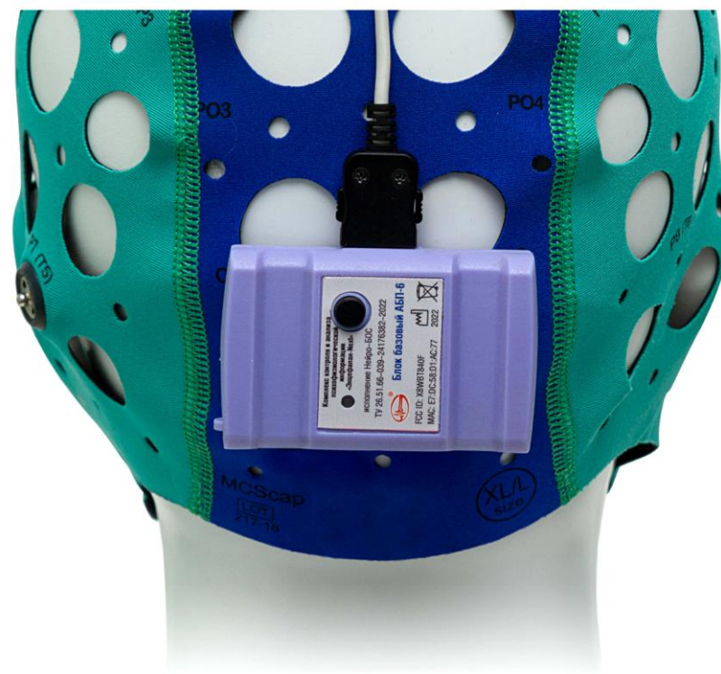
Рисунок 3 – Пример размещения блока АБП-6 на ТЭШ-гарнитуре
