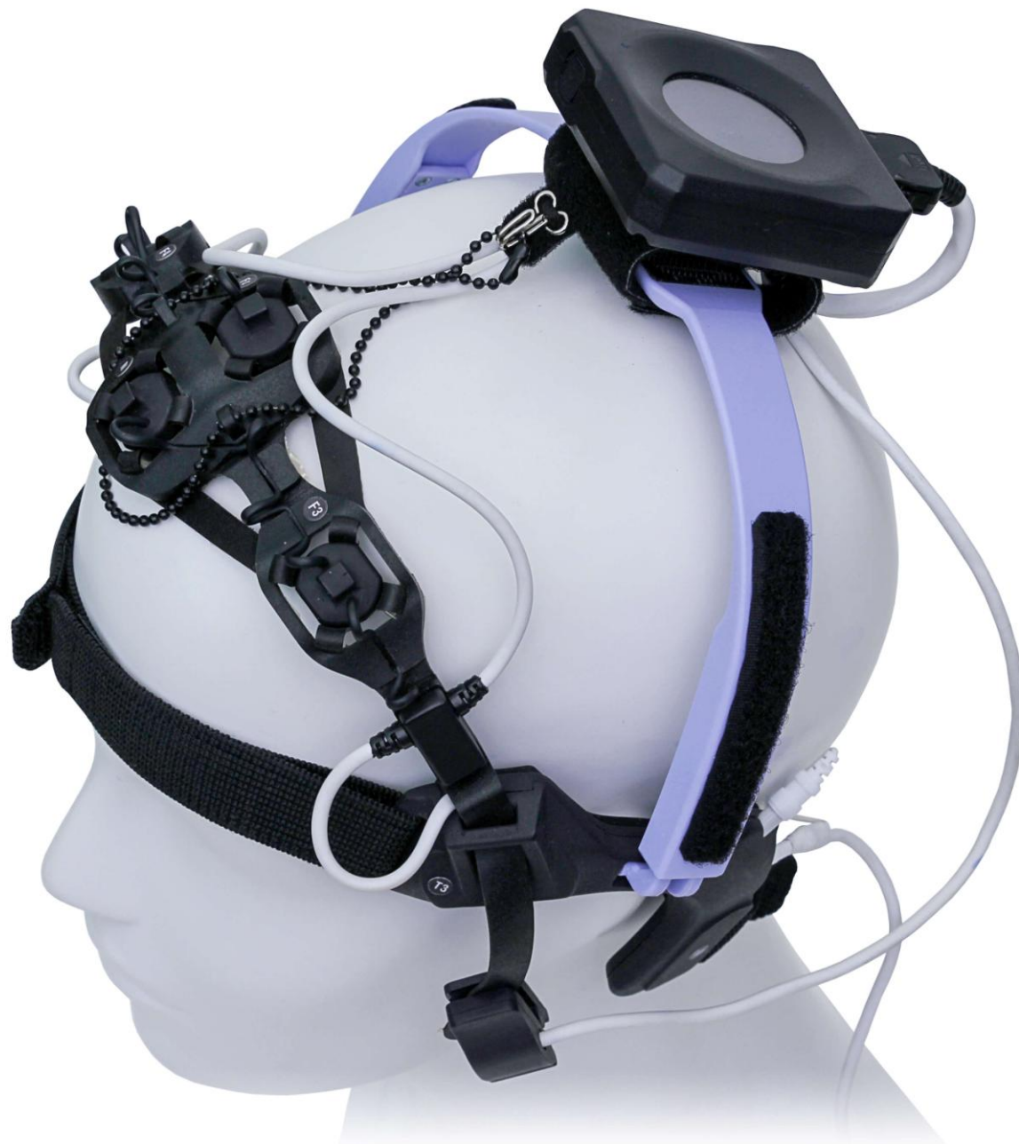
Рисунок 2 – Пример размещения блока АБП-8 на ПТ-гарнитуре.
