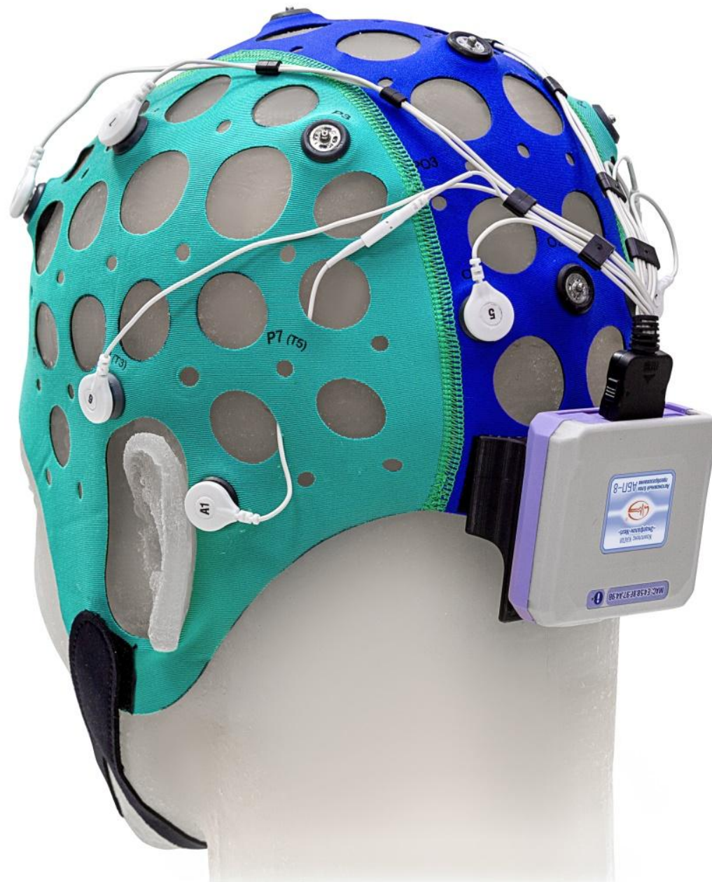
Рисунок 3 – Пример размещения блока АБП-8 на ТЭШ-гарнитуре.
