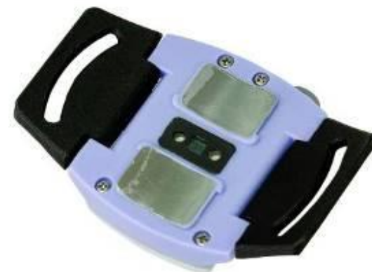
Рисунок 2 – Модуль регистрации ФС со стороны датчиков
