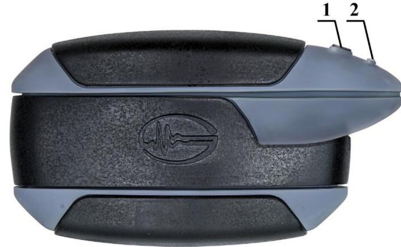
Питание модуля осуществляется от встроенного аккумулятора, зарядка которого должна выполняться от покупного зарядного устройства с USB выходом и напряжением 5 В через кабель с разъёмами USB-A и type-C из комплекта поставки Комплекса.
