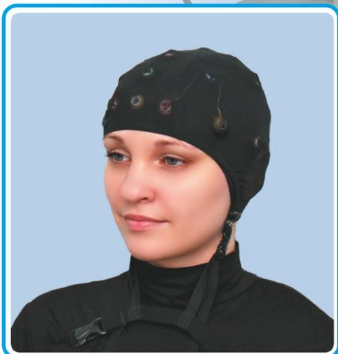
Особенностью электродных систем комплекта является способ закрепления и позиционирования электродов ЭЭГ в специальных установочных гнездах, находящихся на фиксирующем эластичном сетчатом шлеме. Электрод и соответствующее ему установочное гнездо имеют одинаковый цвет. Каждый электрод имеет проводник строго определённой длины от концентратора общего кабеля. Проводники группируются в жгуты для удобного распределения по левому и правому полушарию, лбу и затылку. (Патент РФ № 2230483)
