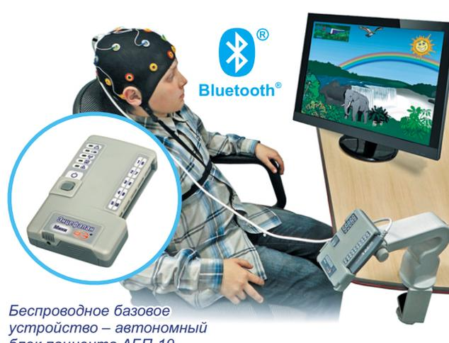
Беспроводное базовое устройство – автономный блок пациента АБП-10
